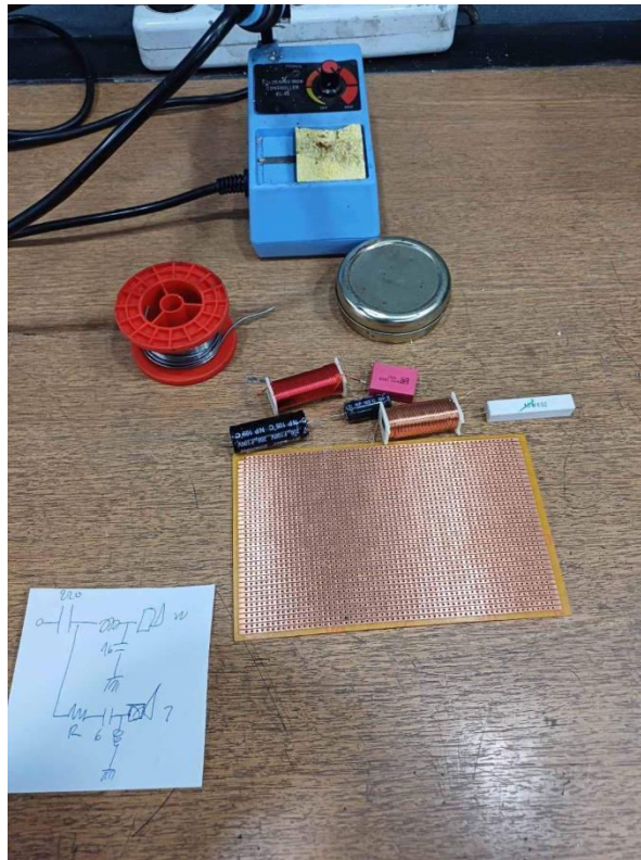
Εικόνα6.14 Υλικά για κατασκευή crossover
