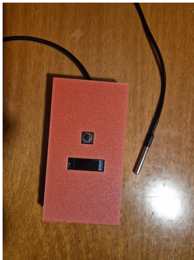
Εικόνα 3. 20 Ολοκληρωμένη κατασκευή θερμομέτρου επαφής
