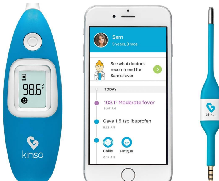
Εικόνα 2. 7 Έξυπνα θερμόμετρα με επικοινωνία μέσω εφαρμογής κινητού τηλεφώνου
