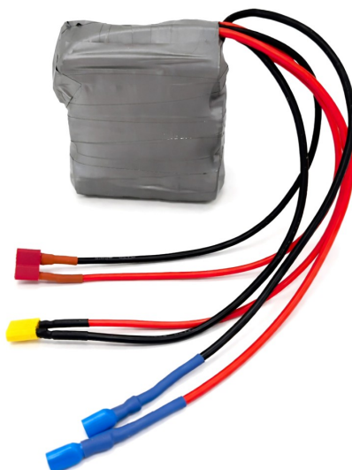
Εικόνα 5.23: Ολοκληρωμένη συστοιχία μπαταριών μετά τη συναρμολόγηση και μόνωση.
