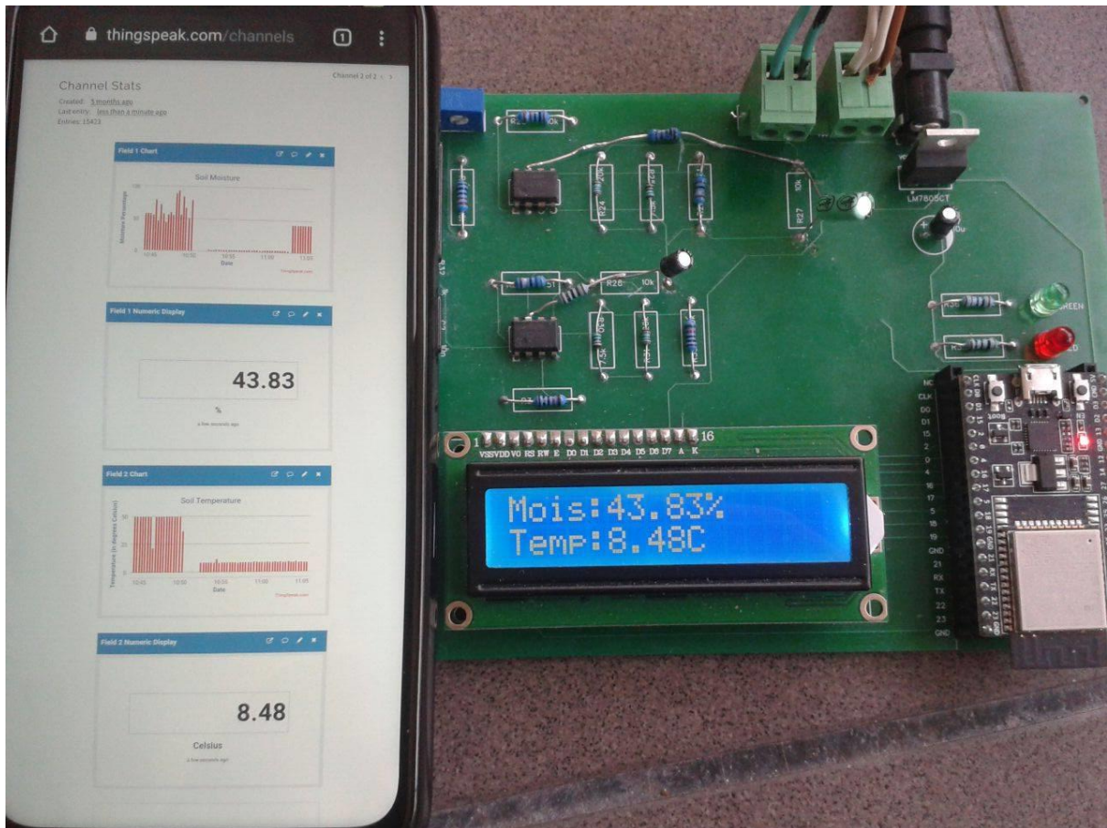
Εικόνα 4.8: Οι μετρήσεις όπως εμφανίζονται στην οθόνη της μετρητικής διάταξης και όπως φαίνονται στο ThingSpeak™
