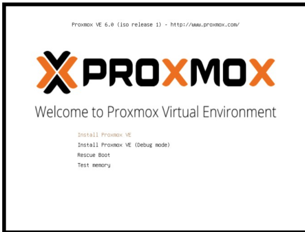
Σχήμα 1: Αρχικό Prompt Οδηγού Εγκατάστασης του Proxmox
