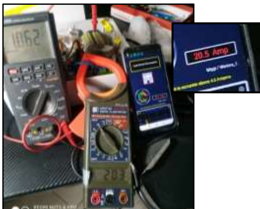
Εικόνα 55: Σύγκριση των αποτελεσμάτων μετρήσεων στην περιοχή των 20A
