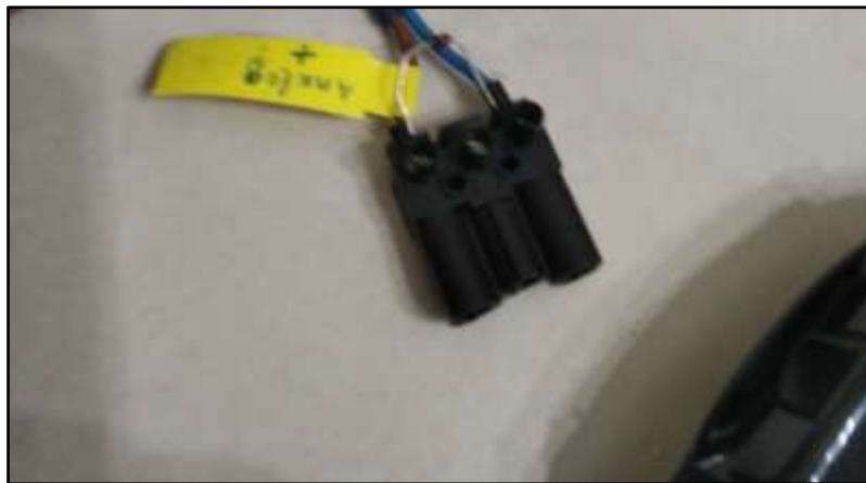
Figure 22: Κουμπωτή κλεμα για την σύνδεση του InDoor Unit με το OutDoor Unit Analog output
