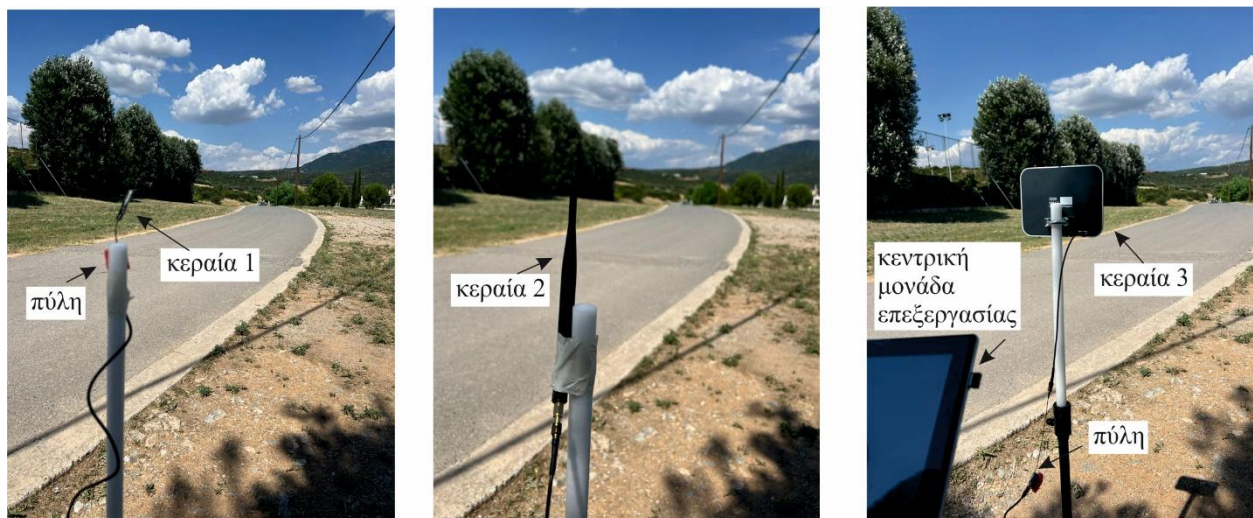
Εικόνα 23. Συγκριτική ανάλυση με διαφορετικές κεραίες πύλης
