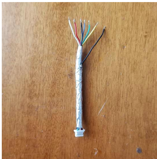
Εικόνα 2.19: Μόνωση καλωδίων GPS
