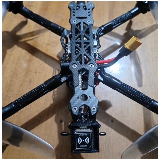
Εικόνα 2.20: Η τοποθέτηση του πάνω καλύμματος του πλαισίου
