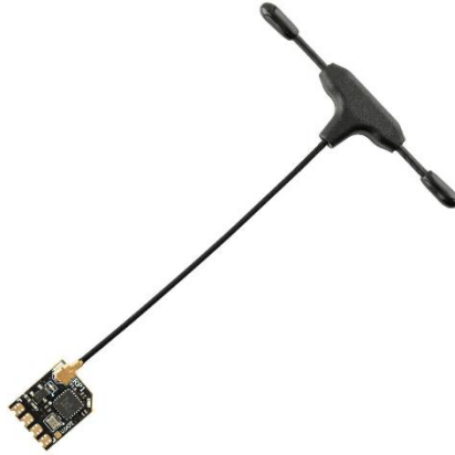
Εικόνα 2.12: Ο δέκτης RadioMaster RP1 2,4GHz
