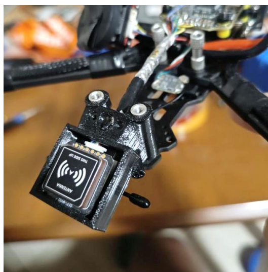
Εικόνα 2.17: Η ενσωμάτωση του GPS και του δέκτη
