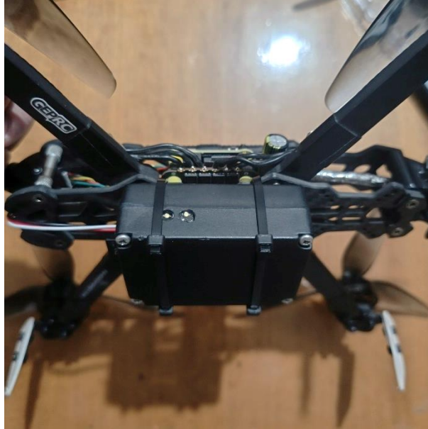
Εικόνα 3.13: Το σημείο τοποθέτησης του ενσωματωμένου συστήματος αισθητήρων
