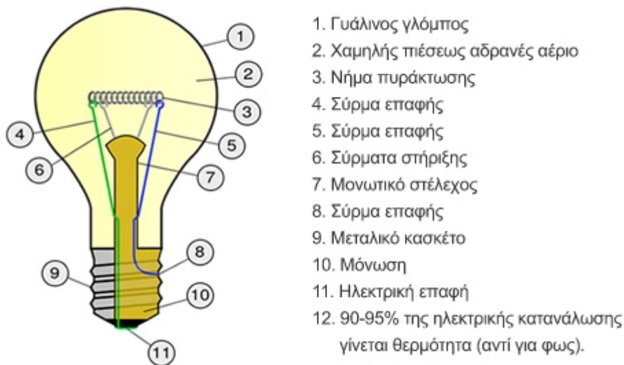
Εικόνα 1.3:Συμβατικός λαμπτήρας πυράκτωσης
