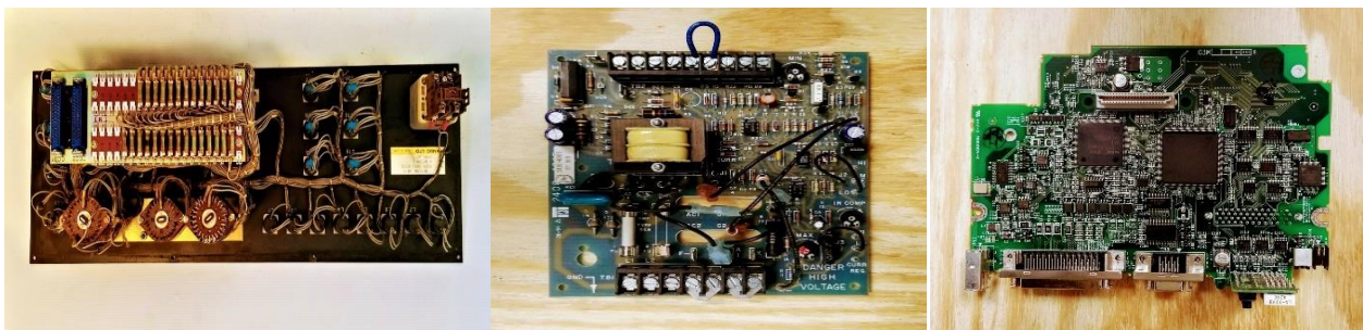
Σχήμα 2.1: Εξέλιξη πλακετών PCB
