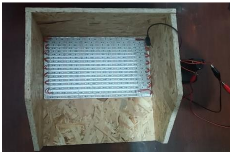
Σχήμα 3.2: Ξύλινος σκελετός θαλάμου
