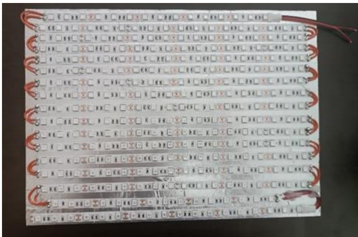
Σχήμα 3.1: Ταινία LED πάνω στο κόντρα πλακέ
