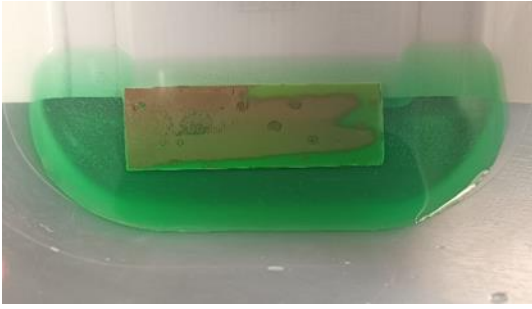
Σχήμα 4.5: Διαδικασία αποχάλκωσης μέσα στο χημικό διάλυμα
