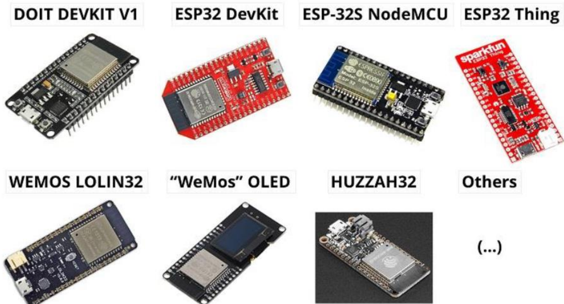
Σχήμα 4.4: Διαφορές πλακέτες που φέρουν πάνω τους μικροελεγκτή της σειράς ESP32.
