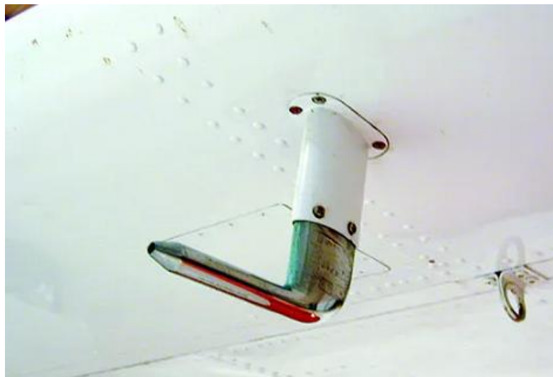
Εικόνα 10. Πιτοστατικός σωλήνας σε αεροσκάφος
