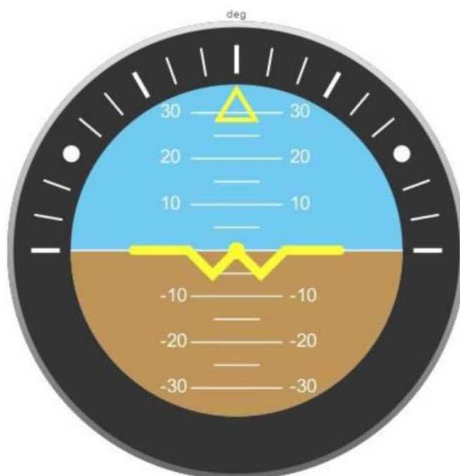
Εικόνα 21. Όργανο τεχνητός ορίζοντας
