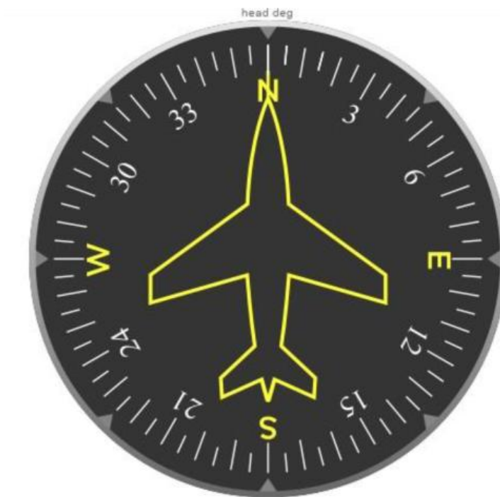
Εικόνα 19. Όργανο πυξίδας αεροσκάφους
