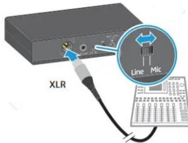
Σχήμα 6.4 : Συνδεσμολογία μικρόφωνων Sennheiser XSW 1-825
