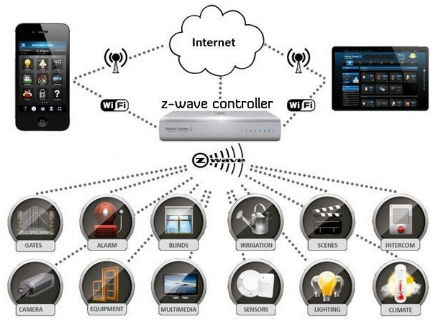
Εικόνα 6 Δίκτυο z-wave για smart home [18]
