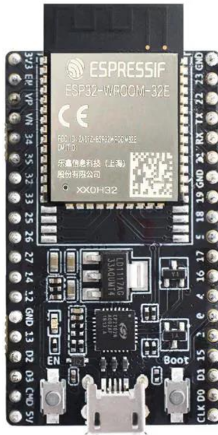
Εικόνα 3.36: Ενδεικτική πλακέτα ανάπτυξης ESP32 με module ESP32-WROOM-32E· η φυσική διάταξη ακροδεκτών μπορεί να διαφέρει ανά board.
