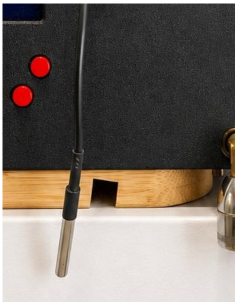
Εικόνα 3.47: Ο μεταλλικός αισθητήρας θερμοκρασίας της πραγματικής κατασκευής, συνδεδεμένος με το υποσύστημα μέτρησης.
