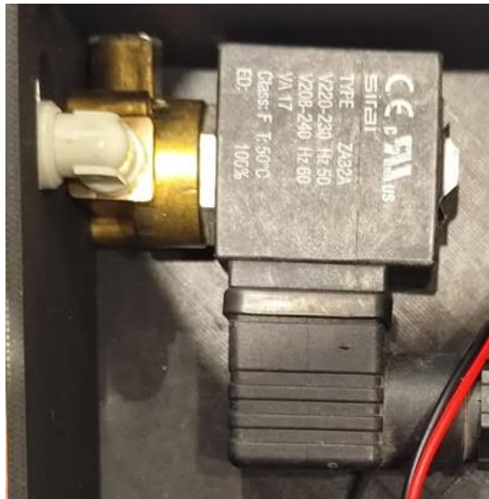
Εικόνα 3.25: Η ηλεκτροβάννα της κατασκευής χρησιμοποιεί πηνίο SIRAI ZA32A, με σήμανση 220–230 V / 50 Hz, 208–240 V / 60 Hz, Class F και ED 100% [37].
