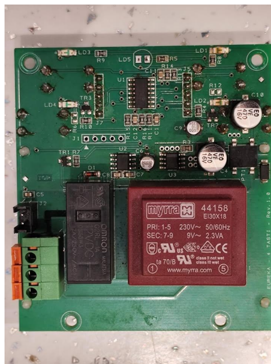
Εικόνα 4.4: Πλακέτα ελέγχου με μικροελεγκτή PIC16F1825.
