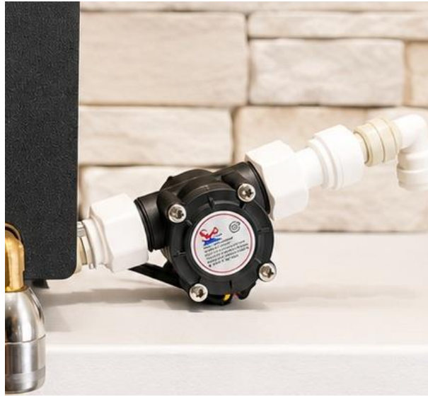
Εικόνα 3.40: Ο αισθητήρας ροής όπως έχει ενσωματωθεί στην πραγματική διάταξη μέτρησης παροχής και όγκου νερού.
