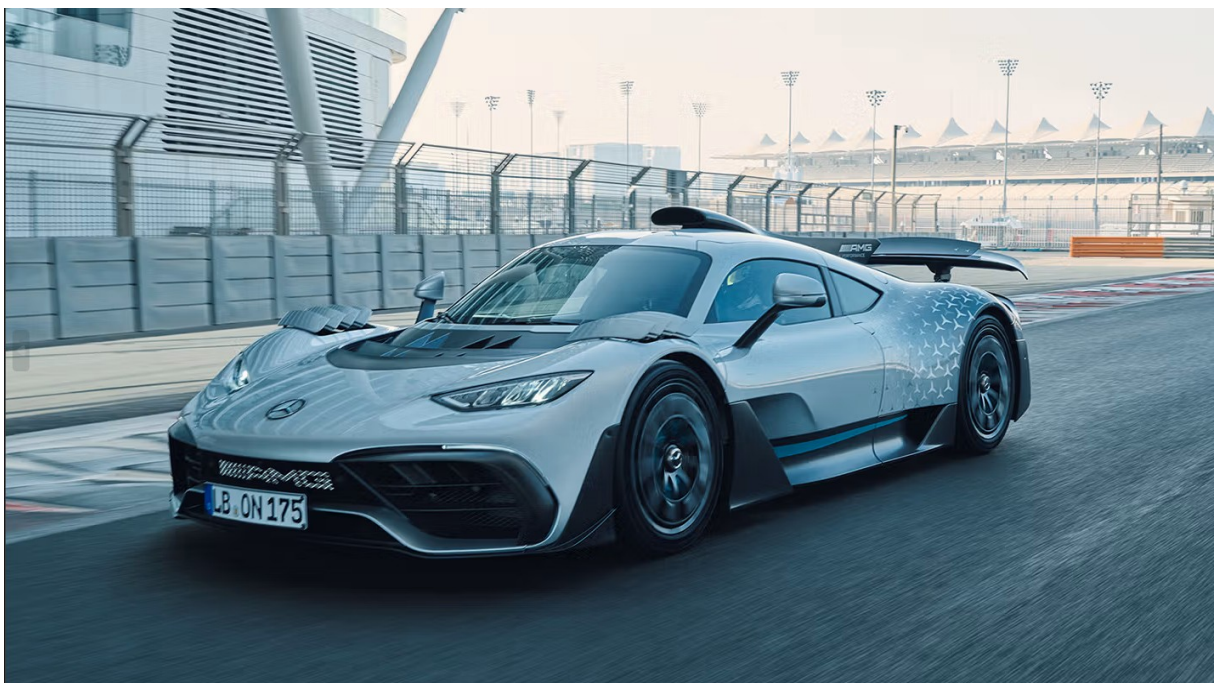
Σχήμα 1.2: Το Mercedes-AMG ONE με όλα τα αεροδυναμικά στοιχεία σε θέση μέγιστης κάθετης δύναμης. Οι περσίδες είναι ενεργοποιημένες κατευθύνοντας τη ροή του αέρα γύρω από το αμάξωμα και προς την πίσω αεροτομή. Η αεροτομή βρίσκεται στη θέση μέγιστης κάθετης δύναμης με την προέκταση ανασηκωμένη, αυξάνοντας τη γωνία προσβολής του αέρα. Πηγή: Mercedes-AMG [2]
