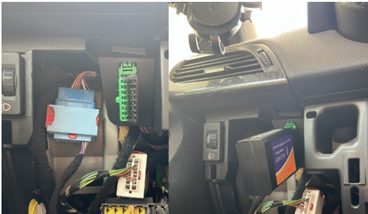
Σχήμα 5.1: Θέση θύρας obd του οχήματος και σύνδεση του ELM327.
