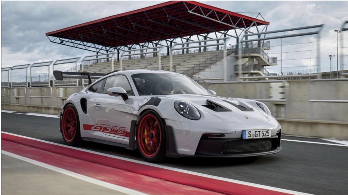
Σχήμα 1.1: Όχημα Porsche 911 GT3 RS με ενεργοποιημένο σύστημα Low Downforce, για χαμηλή παραγωγή κάθετης δύναμης, η πίσω μεταβλητό κομμάτι της αεροτομής βρίσκεται στην ελάχιστη γωνία προσβολής. Πηγή: Porsche AG [1]
