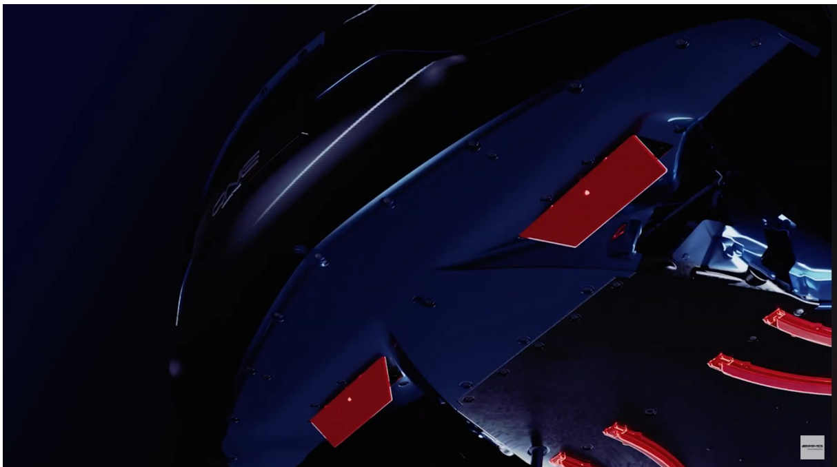
Σχήμα 1.8: Εμπρόσθια ενεργά πτερύγια στο εμπρόσθιο κάτω μέρος του οχήματος και σε θέση ώστε να κατευθύνουν τον αέρα κάτω από το όχημα. Πηγή: Mercedes-AMG [3]
