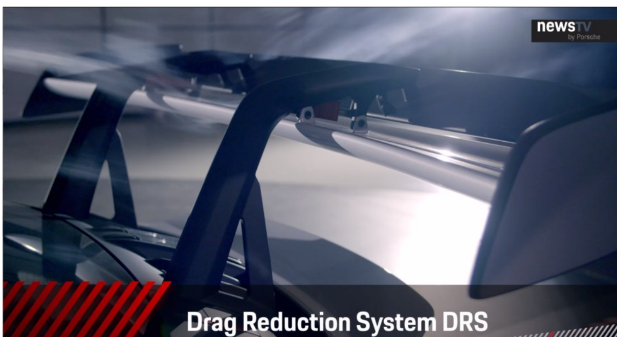
Σχήμα 1.5: Η γωνία κλίσης της αεροτομής βρίσκεται σε 34 μοίρες, η επιφάνεια που έρχεται σε επαφή με τον αέρα προκαλώντας μεγαλύτερη κάθετη δύναμη και αυξημένη αντίσταση του αέρα. Πηγή: Porsche AG [1]
