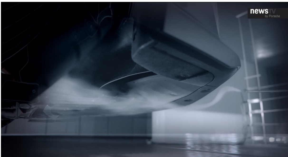
Σχήμα 1.3: Η ροή του αέρα οδηγείται κάτω από το αμάξωμα, αποτρέποντας τον αέρα να διέλθει από τους αεραγωγούς. Πηγή: Porsche AG [1]
