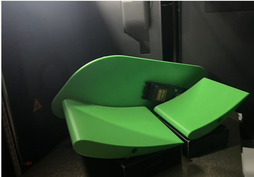
Σχήμα 5.11: Εκτυπωμένη ανατομία ενδεικτικής αεροτομής με την χρήση του 3D Printer Bambu Lab P1S
