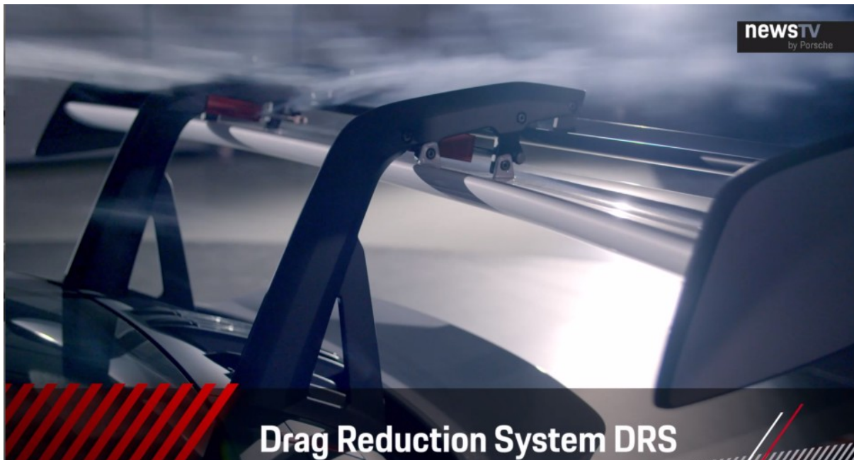
Σχήμα 1.4: Η κλίση της πίσω αεροτομής βρίσκεται σε ιδιαίτερα μικρή γωνία προσβολής με αποτέλεσμα η αντίσταση του αέρα είναι σε εξαιρετικά χαμηλότερα επίπεδα. Πηγή: Porsche AG [1]
