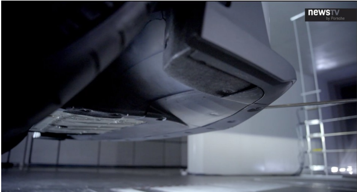
Σχήμα 1.6: Η γωνία από εμπρόσθια πτερύγια, οδηγεί την ροή του αέρα μέσα από τους αεραγωγούς, μειώνοντας τη ροή του αέρα κάτω από το αυτοκίνητο. Πηγή: Porsche AG [1]
