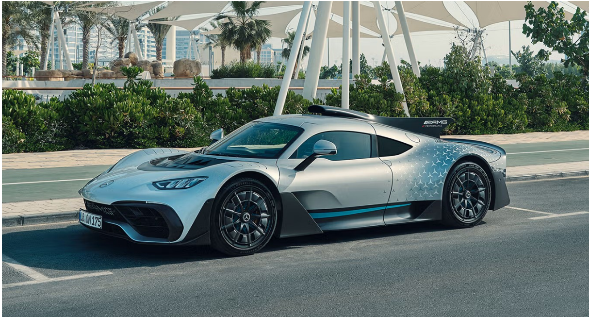
Σχήμα 1.7: Τα ενεργά αεροδυναμικά είναι πλήρως απενεργοποιημένα. Οι περσίδες στα εμπρόσθια φτερά του οχήματος και η αεροτομή στο πίσω μέρος βρίσκονται σε πλήρη απορρόφηση από την μορφή του οχήματος για την ελαχιστοποίηση της παραγωγής της κάθετης δύναμης. Πηγή: Mercedes-AMG [2]
