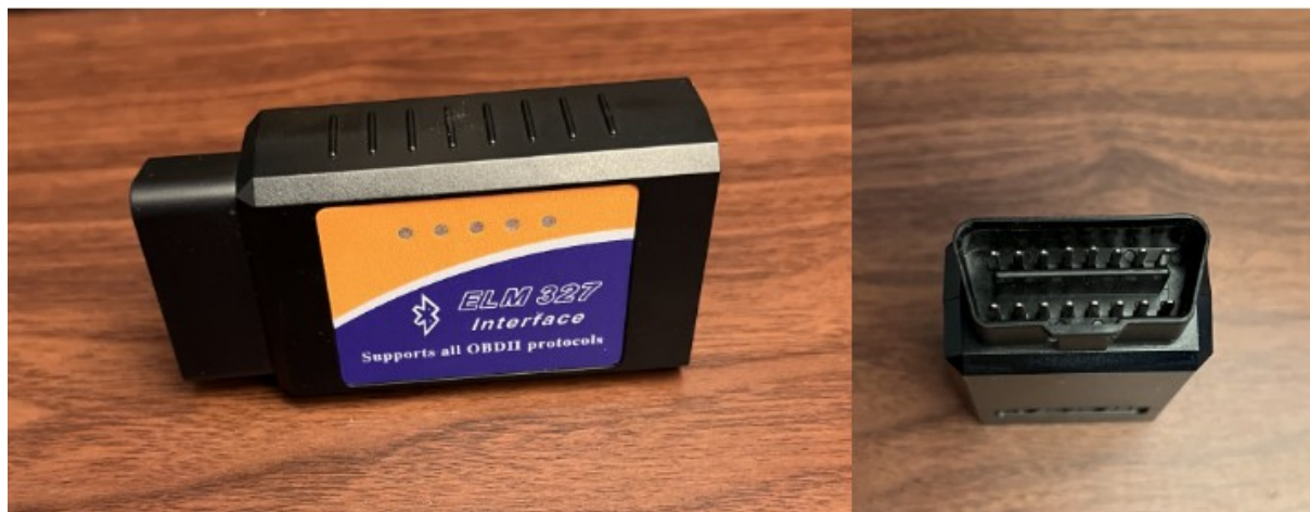
Σχήμα 3.1: OBD-II με ELM327 προσαρμογέα με την επαφή εισόδου.
