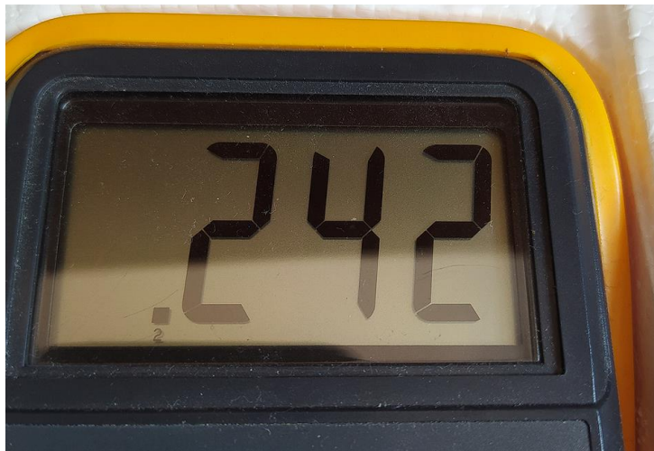
Εικόνα 3.7: Ρύθμιση ελάχιστης τάσης εξόδου AD623.
